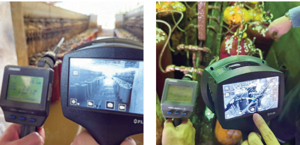
圖 7 超聲波顯像儀快速定位壓力鋼瓶乙炔洩漏
