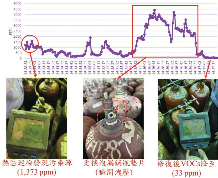
圖 9 FID 定點監控 B 廠乙炔灌裝鋼瓶之修復
