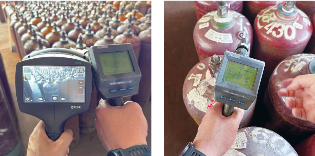
圖 8 A 廠實瓶區壓力鋼瓶乙炔洩漏
